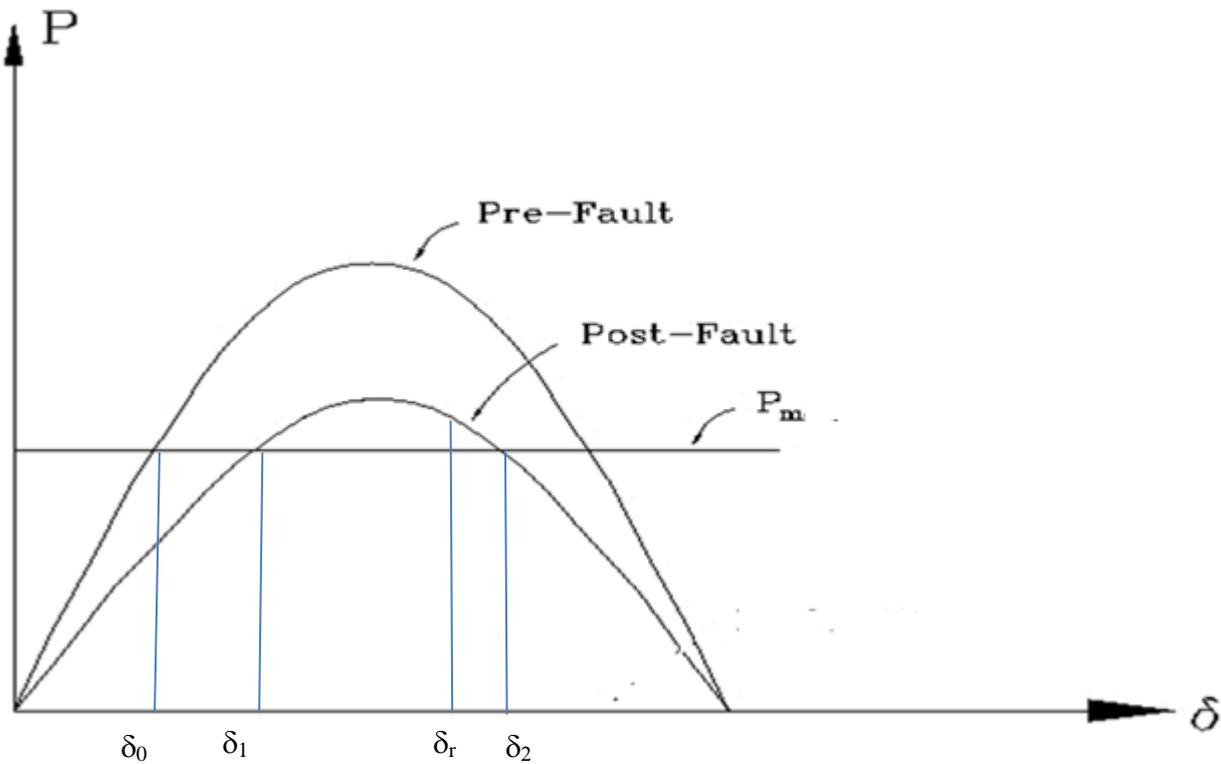
**Fig. 3 : P-angle diagram**
