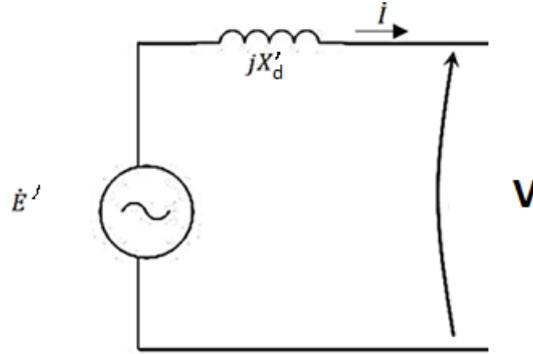
Fig. 5 : Machine equivalent circuit
