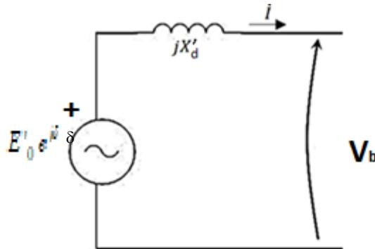
**Fig. 2 : Machine equivalent circuit**
